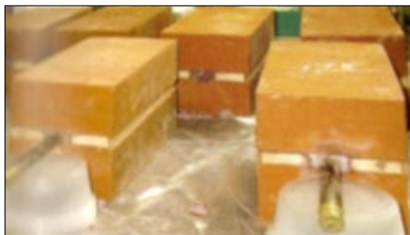
Obr. 29: Zkušební tělesa pro spojovací zkoušky malty-cihla.
