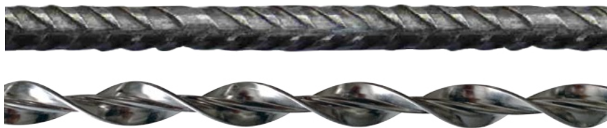
Obr. 32: Porovnání povrchů helikální výztuže d_N=10\text{ mm} s výztužným prutem o průměru d_s=10\text{ mm} .
