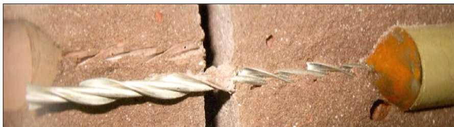
Obr. 35: Otevřené těleso po zkoušce, vlevo je druhá polovina (zrcadlově) s hladkou helikální výztuží a jejím otiskem k vidění.
