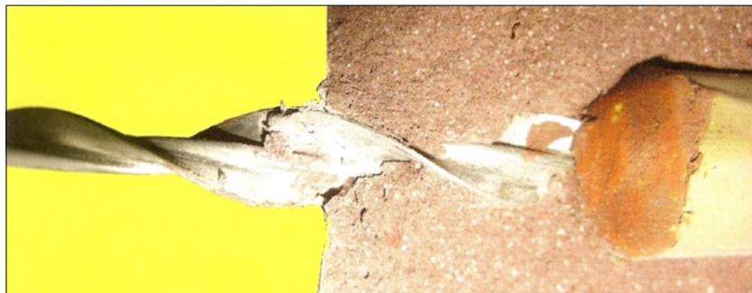
Obr. 35: Rozštípnuté těleso po zkoušce ukazuje drobné spojení adheze.
